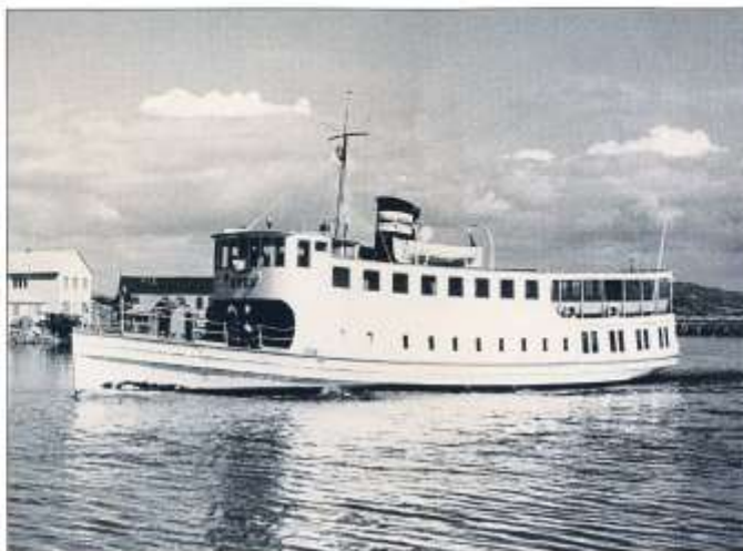
SVEA på väg in i Öckerö botten 16 april 1960. Fördäcklet har höjts, styrhytt och främre delen av övre däck har lygges in liksom huvuddäckets akterut. SVEA bär Öckeröbolagets skorstensmärke. Foto från Sjöfartsmuseet Akvariet
